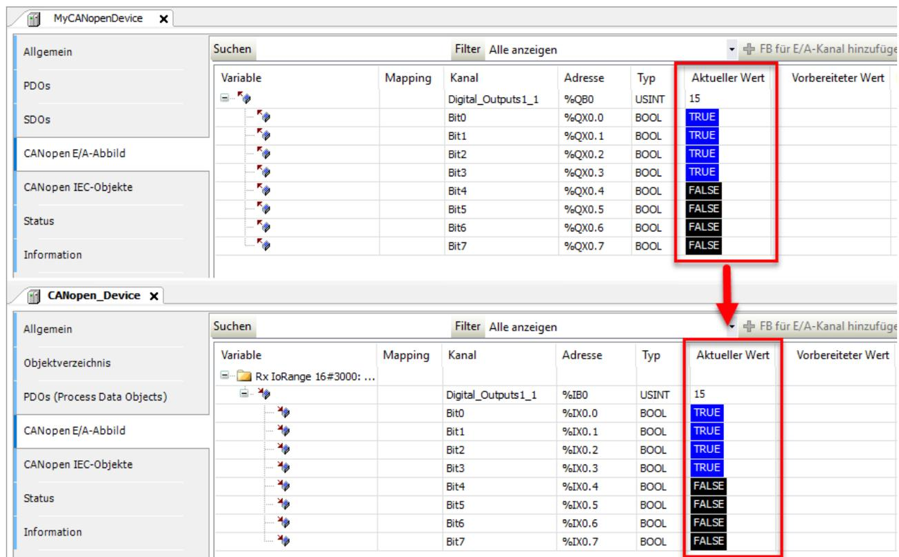
Abbildung 78: CODESYS - CAN-Bus Test - Master und Slave tauschen Daten aus
