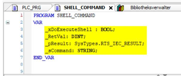
Abbildung 87: CODESYS - Herunterfahren – Variablen
