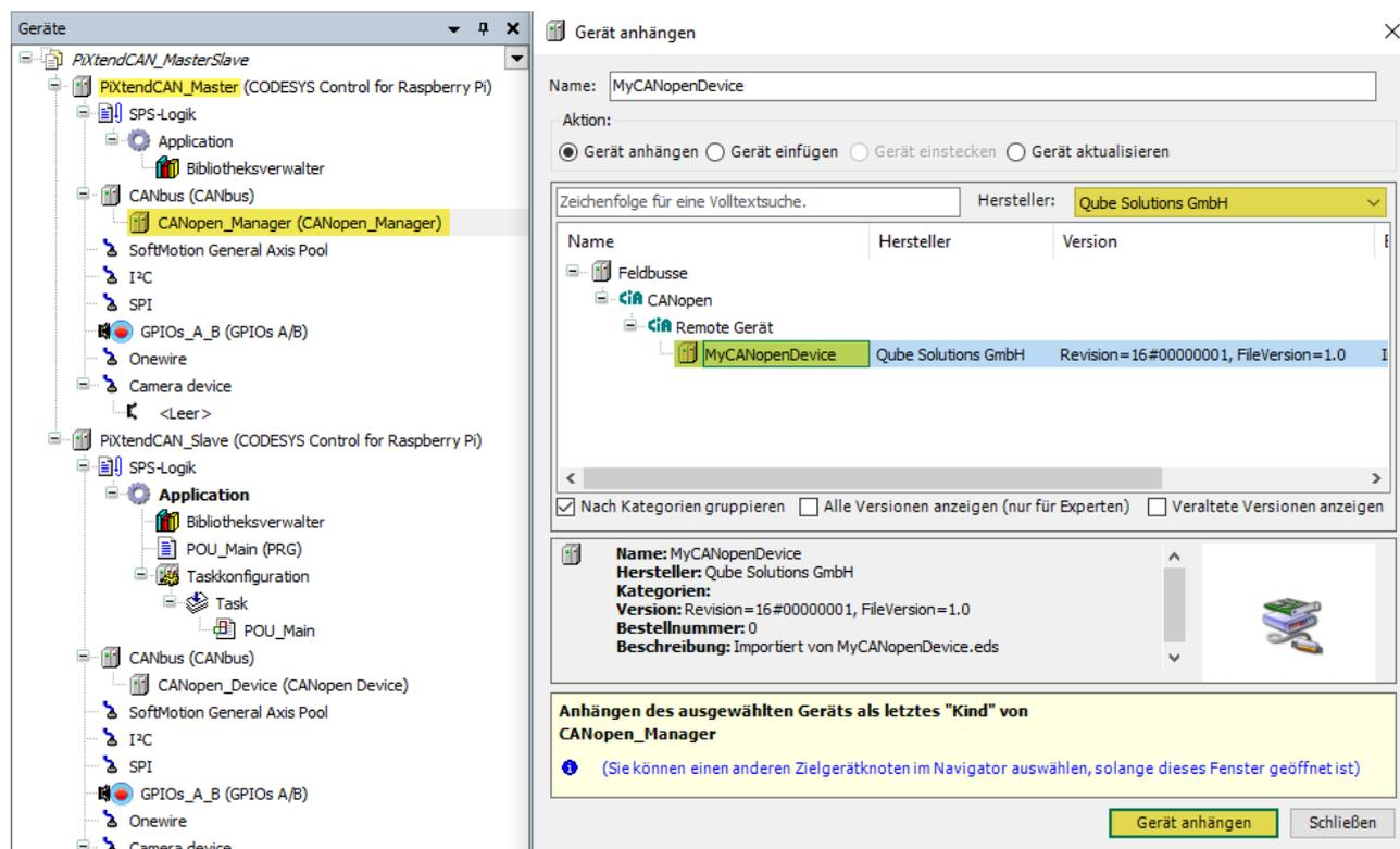
Abbildung 75: CODESYS - CAN-Bus Master - CAN-Bus Slave anhängen
