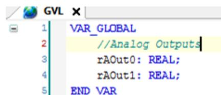
Abbildung 42: CODESYS - DAC - GVL Variablen
