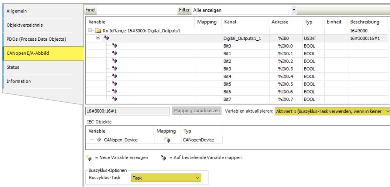
Abbildung 70: CODESYS - CAN-Bus Slave - CANopen E/A-Abbild
