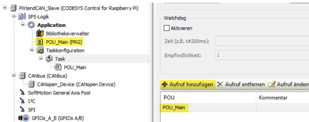
Abbildung 69: CODESYS - CAN-Bus Slave - Taskkonfiguration
