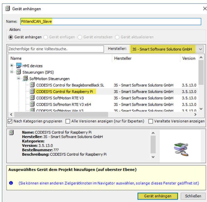
Abbildung 61: CODESYS - CAN-Bus Slave- RPi anhängen
