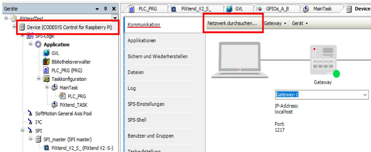
Abbildung 25: CODESYS - Kommunikation - Netzwerk durchsuchen...
