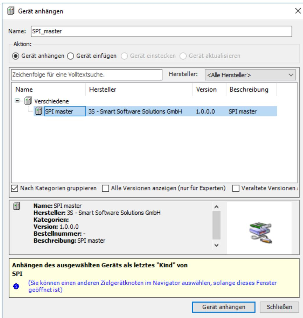
Abbildung 37: CODESYS - DAC - SPI master anhängen
