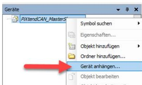
Abbildung 60: CODESYS - CAN-Bus Slave - SPS Gerät anhängen
