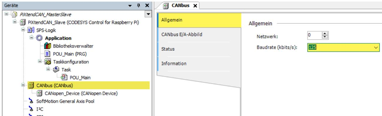
Abbildung 71: CODESYS - CAN-Bus Slave - Baudrate
