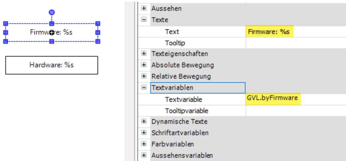
Abbildung 31: CODESYS - Visualisierung - Konfiguration eines Rechtecks
