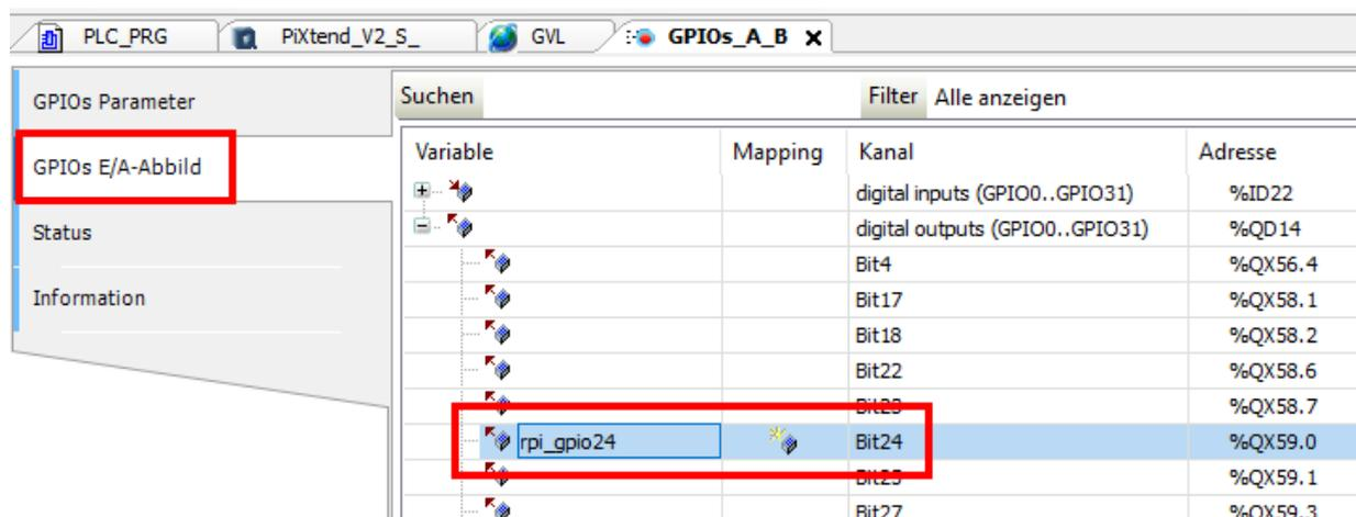
Abbildung 20: CODESYS - GPIO E/A-Abbild - rpi\_gpio24 Variable
