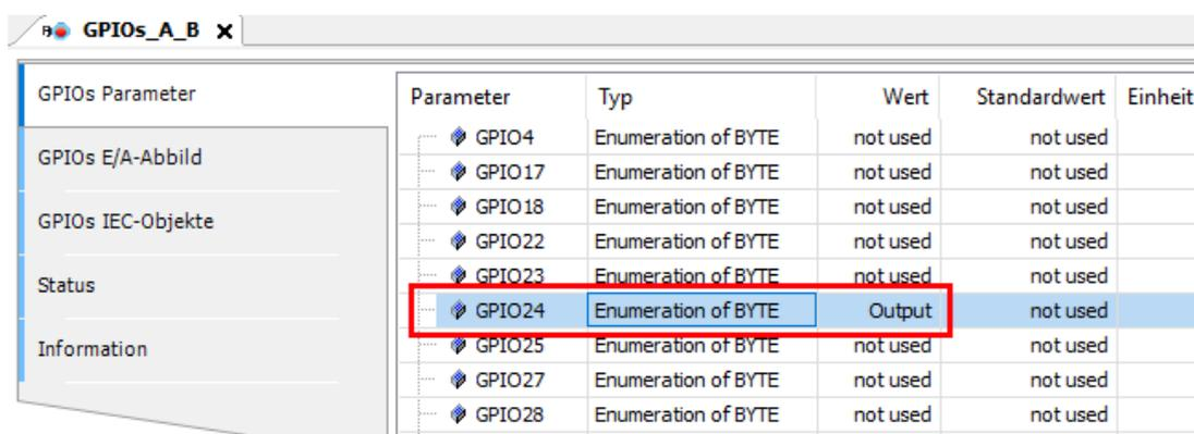
Abbildung 44: CODESYS - DAC - GPIO 24 als Ausgang verwenden
