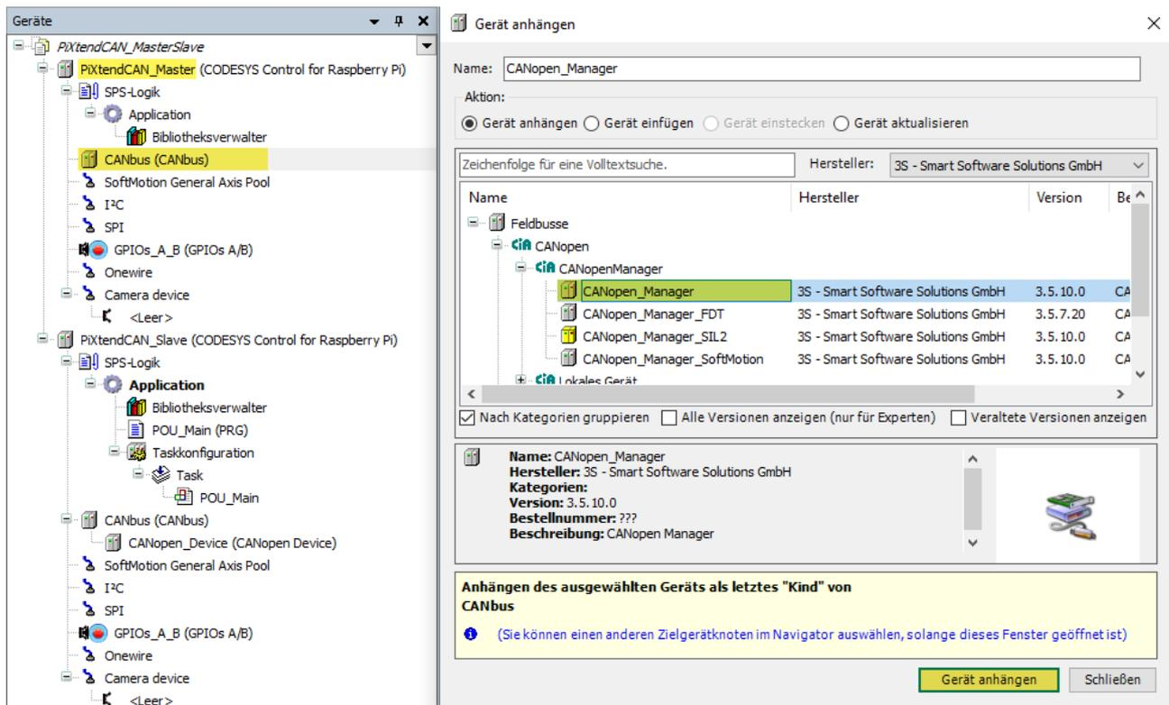
Abbildung 74: CODESYS - CAN-Bus Master - CANopen Manager anhängen
