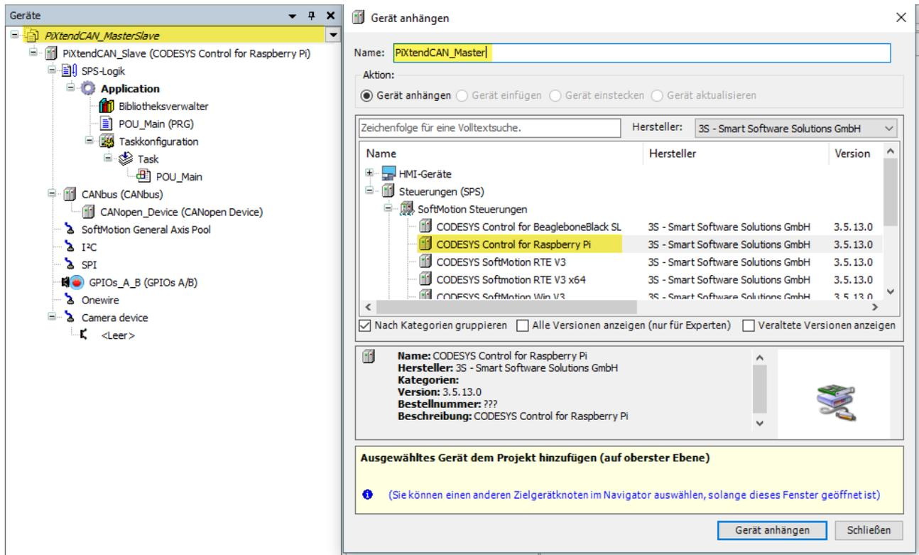
Abbildung 72: CODESYS - CAN-Bus Master - Raspberry Pi anhängen
