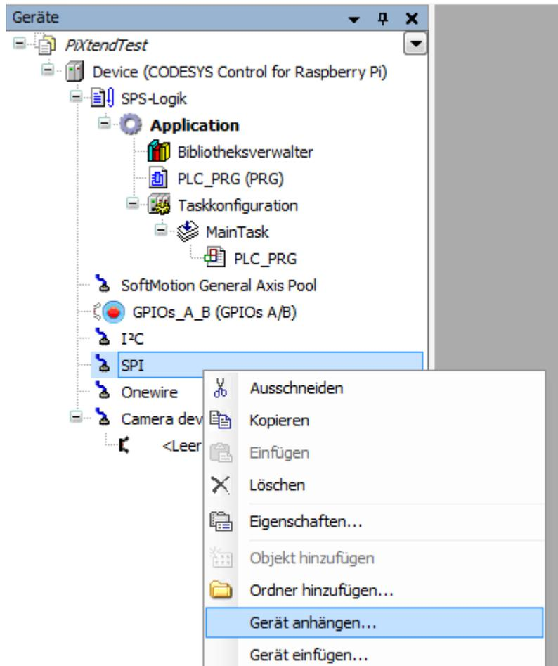
Abbildung 36: CODESYS - DAC - SPI Gerät anhängen
