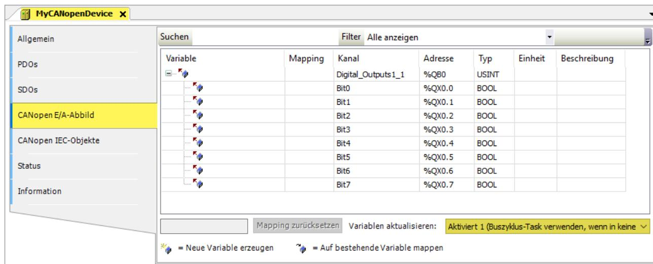
Abbildung 76: CODESYS - CAN-Bus Master - CAN-Slave konfigurieren
