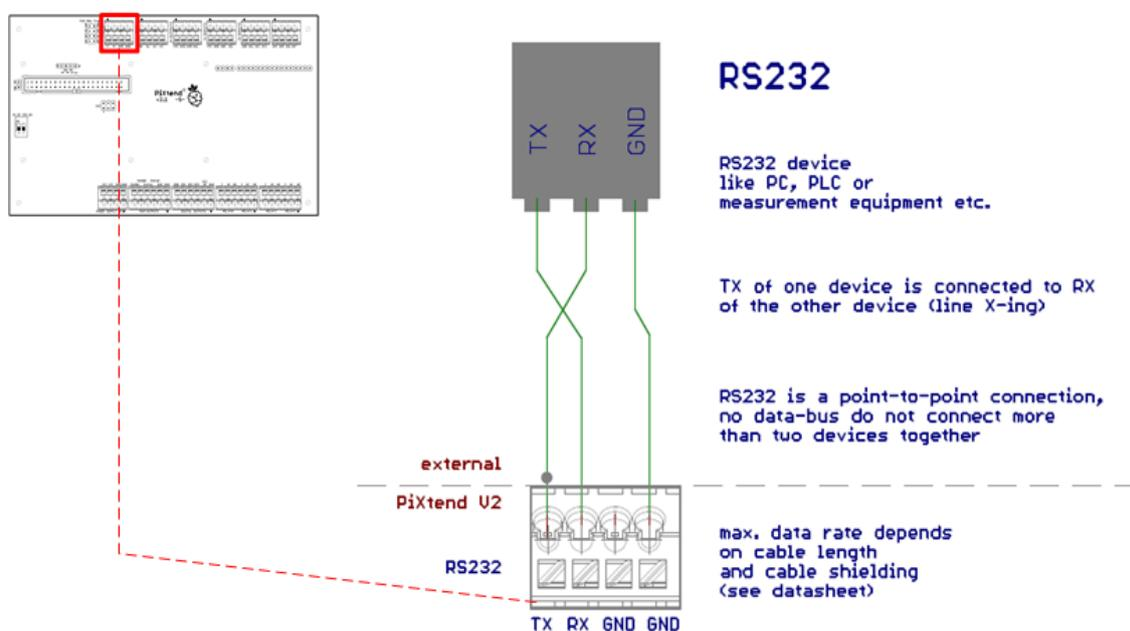
Abbildung 54: CODESYS - Schaltplan RS232
