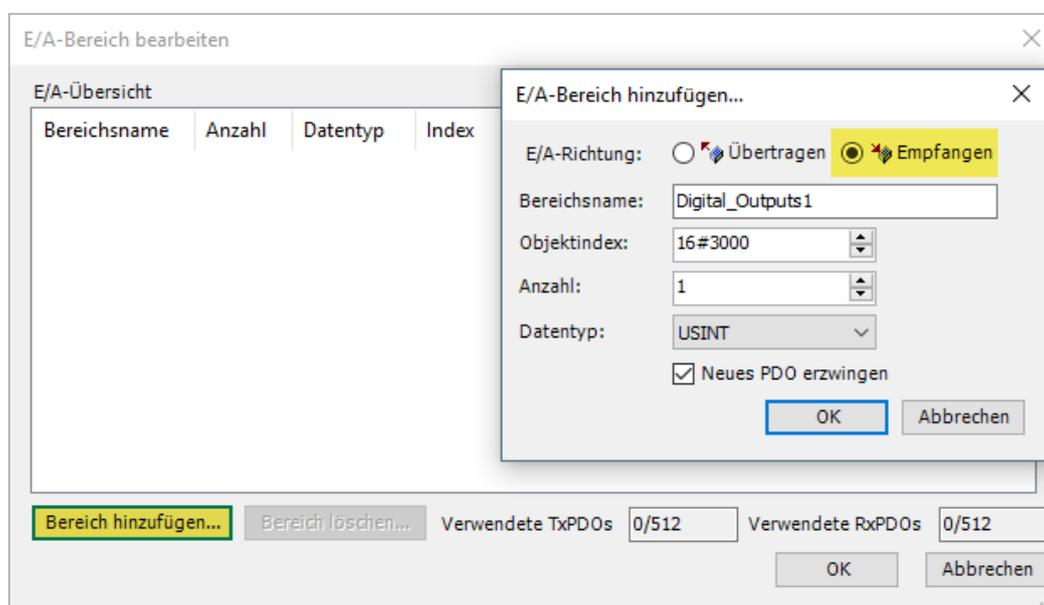
Abbildung 66: CODESYS - CAN-Bus Slave - PDO festlegen
