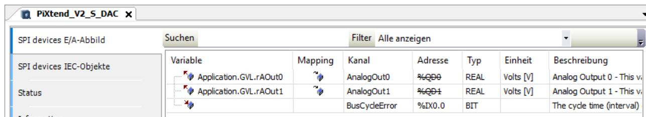
Abbildung 43: CODESYS - DAC - Variablenmapping
