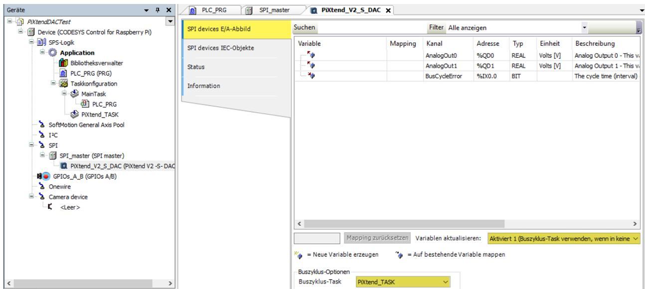
Abbildung 40: CODESYS - DAC - E/A Abbild Einstellungen
