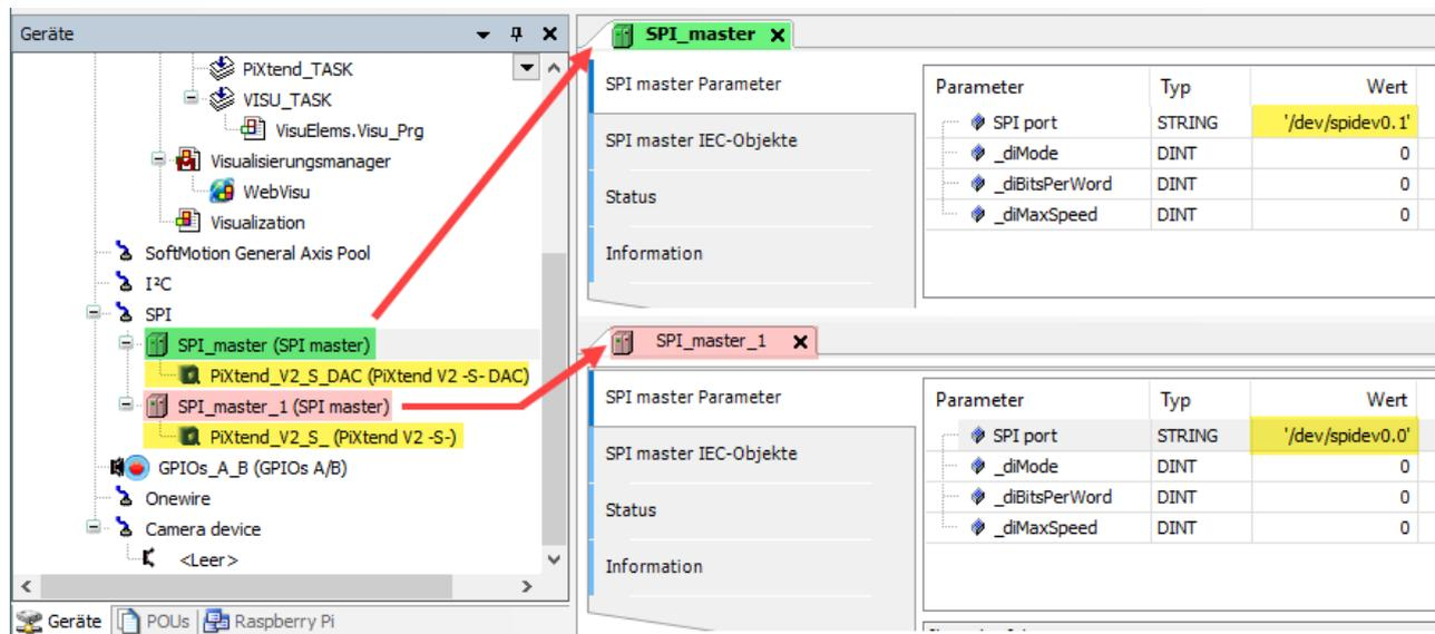
Abbildung 53: CODESYS - Hinweis zur Verwendung beider PiXtend V2 SPI Geräte
