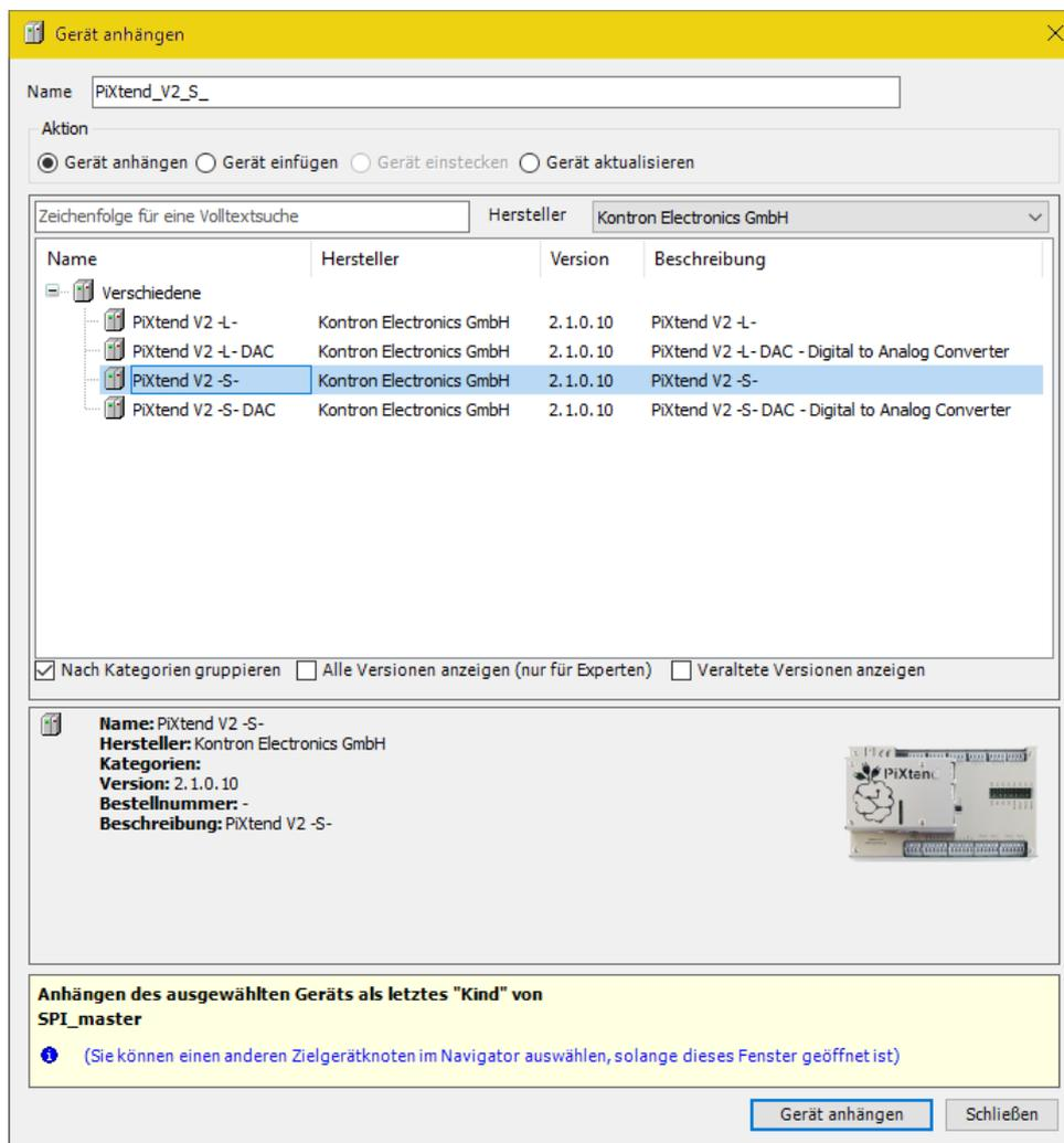
Abbildung 13: CODESYS - Gerät anhängen - PiXtend V2 -S-
