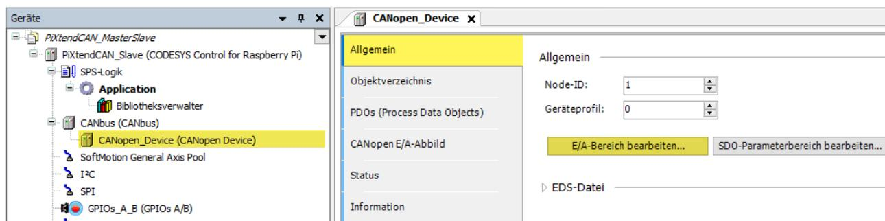
Abbildung 65: CODESYS - CAN-Bus Slave - E/A-Bereich konfigurieren
