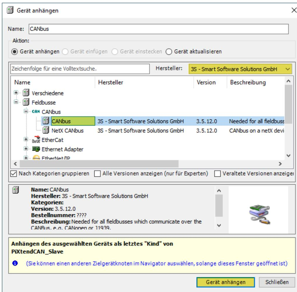
Abbildung 63: CODESYS - CAN-Bus Slave - CAN-Bus-Gerät anhängen
