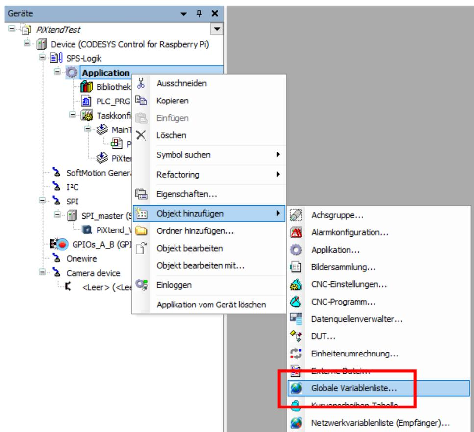
Abbildung 14: CODESYS - Globale Variablenliste einfügen
