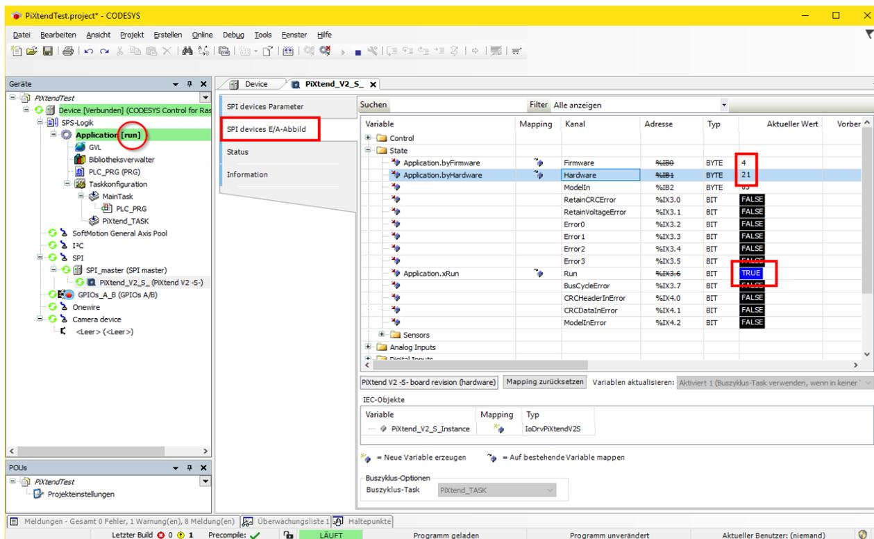
Abbildung 26: CODESYS - PiXtend V2 -S- E/A-Abbild online
