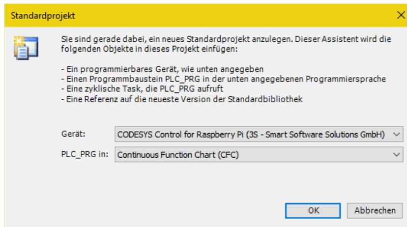
Abbildung 9: CODESYS - Neues Projekt - Auswahl Gerät
