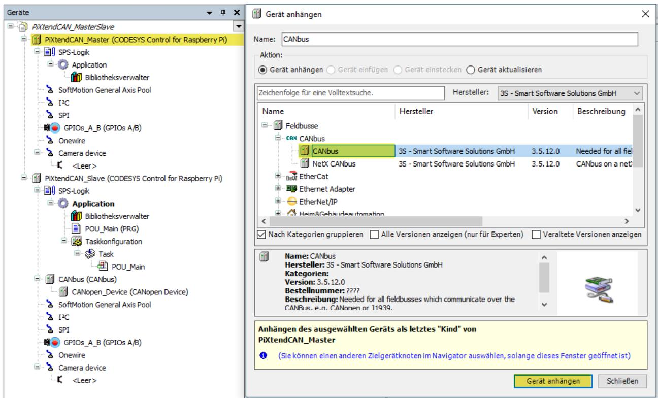
Abbildung 73: CODESYS - CAN-Bus Master - CANbus anhängen
