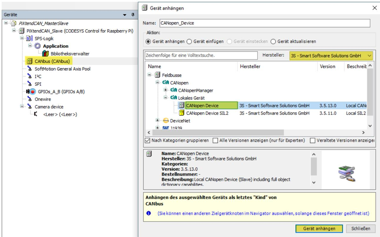
Abbildung 64: CODESYS - CAN-Bus Slave - CANopen Device Gerät anhängen
