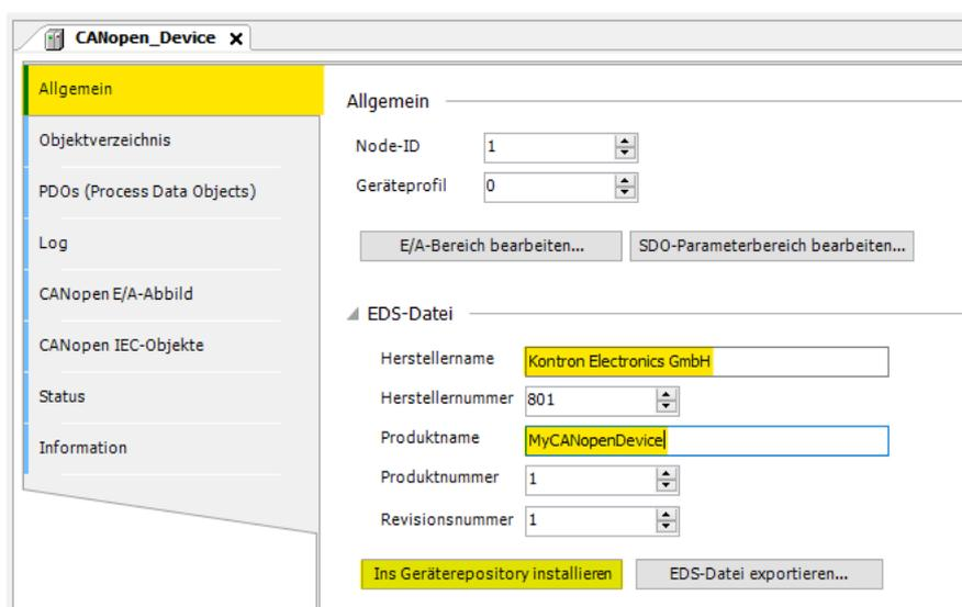
Abbildung 67: CODESYS - CAN-Bus Slave - Eigenes CAN-Gerät installieren
