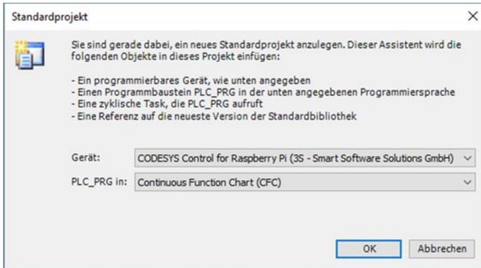
Abbildung 34: CODESYS - DAC - Gerät auswählen
