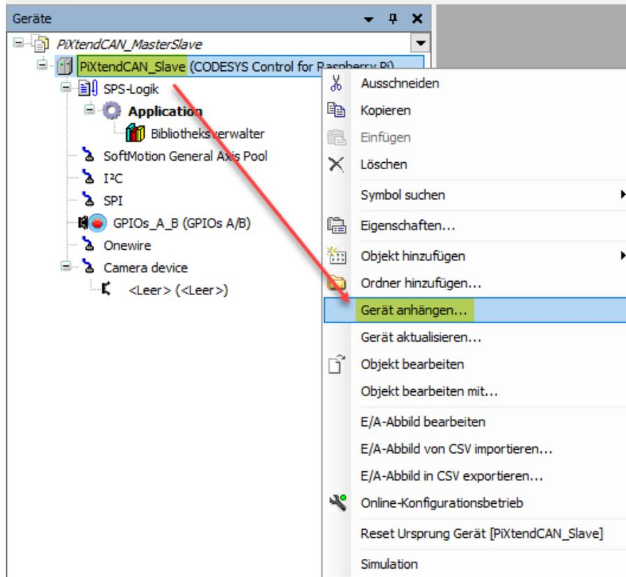
Abbildung 62: CODESYS - CAN-Bus Slave - Gerät an SPS anhängen
