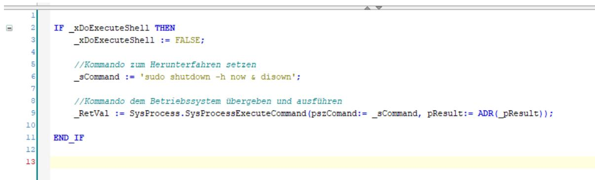
Abbildung 88: CODESYS - Herunterfahren - Beispielprogramm
